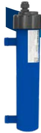
Cette lampe UV est spécialement conçue pour les températures élevées ( $\pm 40^{\circ}\text{C}/\pm 104^{\circ}\text{F}$ ). Le Blue Lagoon Spa UV-C T5 21 W a un ballast électronique avec un indicateur LED ou un signal de sortie 0-5 V, ce qui le rend facile à intégrer et à utiliser dans chaque installation et système de contrôle de spa.
