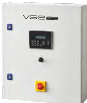
Le régulateur de confort est un régulateur complet pour l'unité moyenne pression 600-85 ou 1200-85. Le contrôleur peut éventuellement être équipé d'un capteur UV pour mesurer l'intensité UV-C à l'intérieur de la chambre de traitement. De plus, il convient à un capteur de température ou à un ModBus. Le capteur de température surveille la température dans la chambre de traitement pour éviter la surchauffe. Le contrôleur est disponible dans différentes langues.
