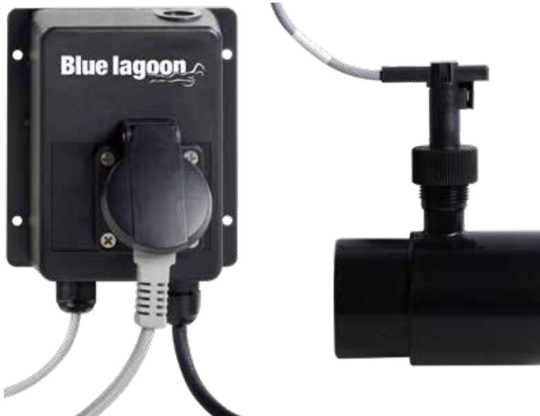
Der Flow Switch Plus ist der ideale Schutz für ein UV-C-Desinfektionssystem in Ihrer Schwimmbadanlage. Der Flow Switch Plus schaltet die Lampe ab wenn der Fluss zu schwach ist.
