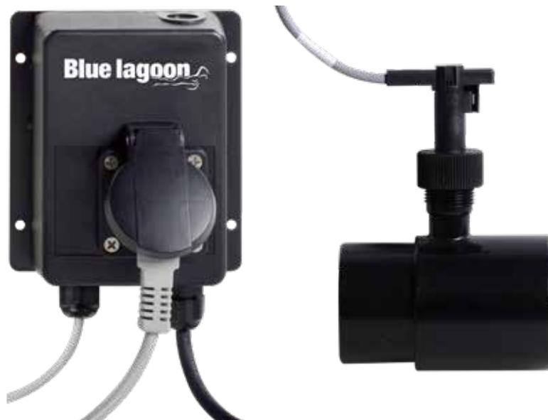
Le Flow Switch Plus correspond à la protection idéale et économique pour un système de désinfection UV-C pour votre bassin. Un contacteur de débit désactive la lampe lorsque le débit d'eau est insuffisant.
