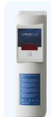
El Temporizador de control tiene una pantalla LED que muestra las horas de funcionamiento de la lámpara. El número máximo de horas de uso se muestra cuando al poner en marcha el sistema. A continuación, la pantalla inicia una cuenta atrás hasta 0, momento en el cual deberá reemplazarse la lámpara.
