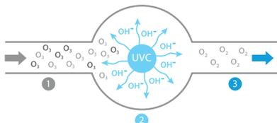
La lampe a une double fonction, produisant à la fois de l'ozone et un rayonnement UV-C. L'ozone dans l'eau sera entièrement décomposé par le rayonnement UV-C. En raison de cela, des radicaux  $\cdot\text{OH}$  sont produits, ayant un potentiel d'oxydation élevé. Cela entraîne l'oxydation de la pollution organique dans l'eau, et le rayonnement UV-C désinfecte simultanément l'eau.
